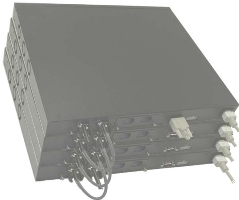
図 1-3 スwitchのスタックの接続
